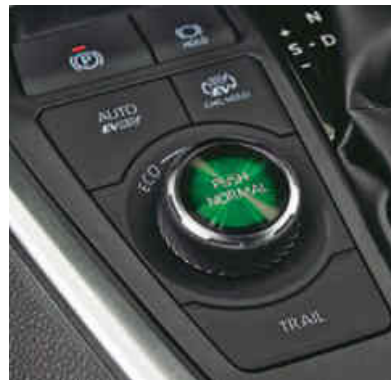
In den vier Fahrprogrammen lässt sich zwischen Normal, Eco und Sport wählen. Der Modus Trail unterstützt bei Offroad-Fahrten.
